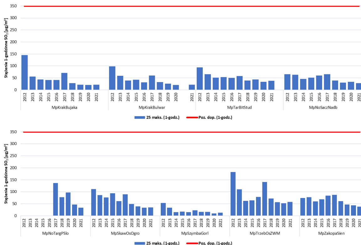
Rysunek 7.3. Przebieg 25 maksymalnej wartości godzinowej stężenia dwutlenku siarki na poszczególnych stanowiskach pomiarowych w województwie małopolskim na tle poziomu dopuszczalnego w latach 2012 – 2021 [źródło: GIOŚ]
